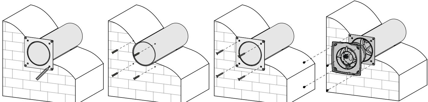
6. Встановіть фронтальну частину кімнатного блоку на попереднє місце та закріпіть самонарізом за допомогою викрутки.
