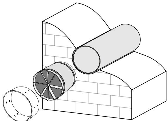
4. За допомогою викрутки викрутіть самонаріз з корпусу та зніміть фронтальну частину кімнатного блоку.
