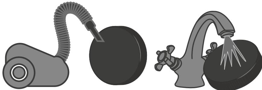
2. Навіть за умови регулярного технічного обслуговування фільтрів на регенераторі та вентиляторі можуть накопичуватися пилові відкладення.
