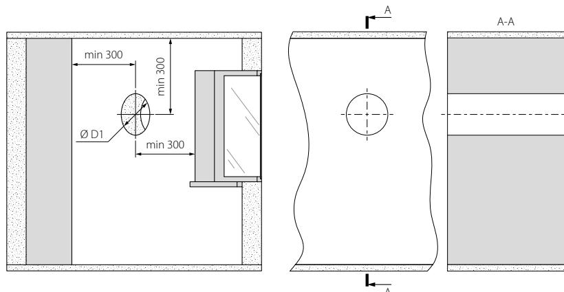
2. Встановіть повітropровід в отвір так, щоб його зрізи збігалися із зовнішньою та внутрішньою поверхнею стіни. Для зручності монтажу використовуйте пінопластові клини, які входять до комплекту постачання.
